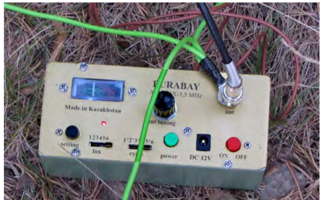
1558. De ARDF 80 m zender was door de amateurs van Kazachstan zelf gebouwd. Foto PA0DFN
