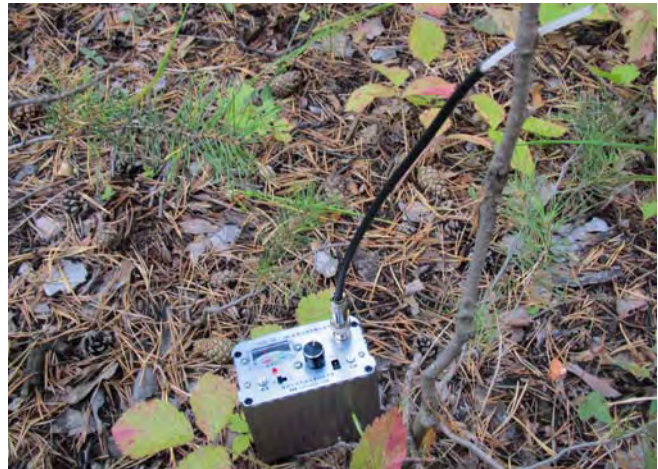
1557. 2014: Een Chinese 80 m zender voor de Sprint en de Foxoring. De buitenmantel van de coax werd aan het eind verwijderd, de lengte van de vrije binnenader bepaalde de toepassing. Deze was slechts een 10-tal cm bij de Foxoring.
