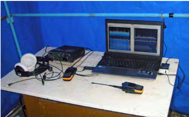
1587. 2014: In een extra tenthuisje in de buurt van de start stond een opstelling met ontvangers en een spectrum analyzer voor de controle op de uitzendingen van de vossen. Foto UN9LU
