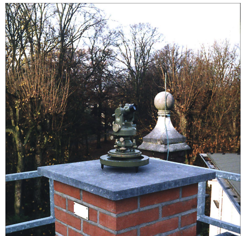
Fig. 3 Een Wild T0 Boussole-theodoliet, opgesteld op de geodetische pijler op het waarneemdak van de Utrechtse sterrenwacht 'Sonnenborgh'. Met een dergelijk meetinstrument kan onder andere de magnetische declinatie nauwkeurig worden bepaald. (Foto: P.J.K. Louwman)
