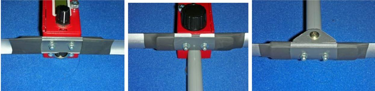
Die Fotos zeigen jeweils die Mitte mit der Halterung von Reflektor, Strahler (in der Mitte unterbrochen) und Direktor. Der Direktor wird über einen Alu-Winkel mit dem Boom verbunden. Für den Boom benutze ich 16 mm PVC-Rohr, weil zufällig vorhanden. Die zwei Befestigungsschrauben pro Element haben jeweils 20 mm Abstand. Das Bandmaß zeigt jeweils mit der Rundung nach vor, so weicht es Hindernissen besonders leicht aus.
