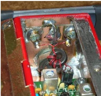
Balun und Strahleranschluss
