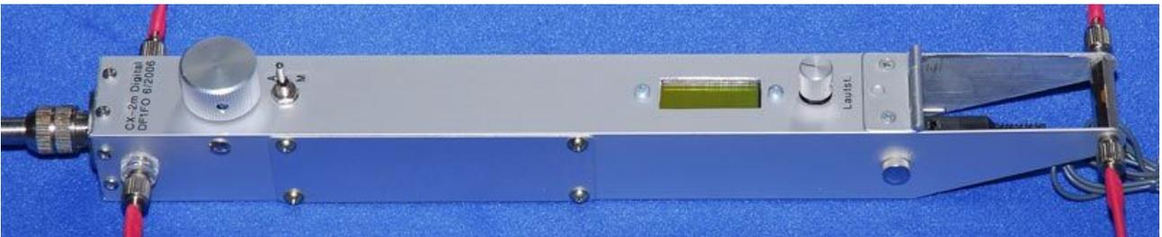
Oben habe ich in das Gehäuse die Bedienelemente eingebaut - von vorne nach hinten den Drehgeber, den Kippschalter, dann kommt etwas freier Platz zum Festhalten, und am hinteren Ende das Display und den Lautstärkereglere. Der Empfänger kann so rechts oder links gehalten werden, Schalter und Drehgeber sind mit dem Daumen erreichbar. Die Platine ist vorne unter dem Drehgeber eingebaut, und hinten unter dem Display sind zwei 9V- Batterien untergebracht.
