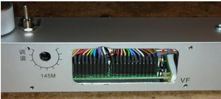
Da, wo das Gehäuse eh schon schwer durchlöchert war (linke Seite vorne), habe ich ein Montageloch reingeschnitten, durch das ich die beiden Vielfachstecker abziehen kann um die Platine auszubauen. Ein Deckel aus 1 mm Alu verdeckt alle Löcher und alten Beschriftungen. Die Kabel habe ich so lang gemacht, dass ich die Platine auch neben dem Gehäuse betreiben kann - für Fehlersuche und Abgleich. Das Gewicht ist mit Antenne und zwei Batterien **760g**.
