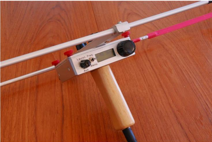
Die Antenne – eine **HB9CV** – ist direkt oben auf den Empfänger aufgesetzt.
