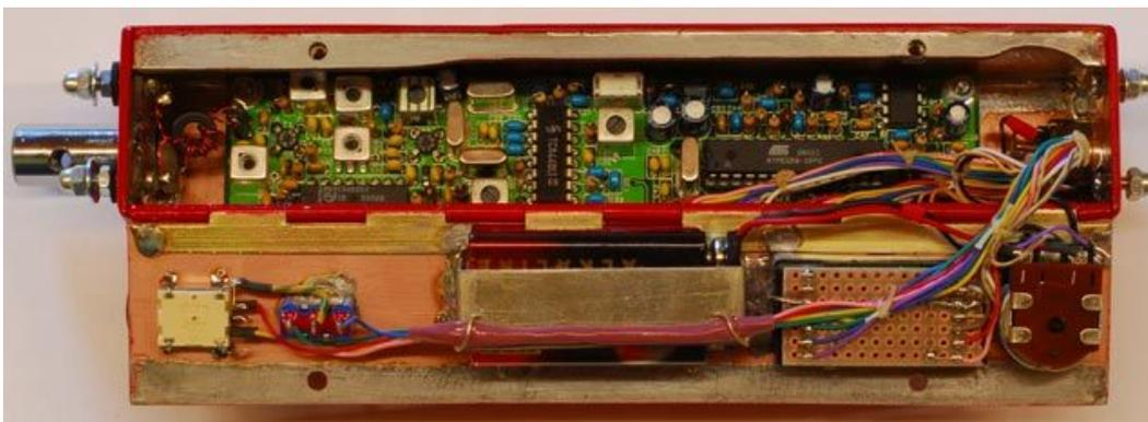
Die **Langversions**-Platine wird 4,5 mm über dem Boden montiert, der Abstand wird mit zwei M3-Muttern erreicht. Zu den Wänden rechts und links hat die Platine nur einen knappen mm Abstand.
