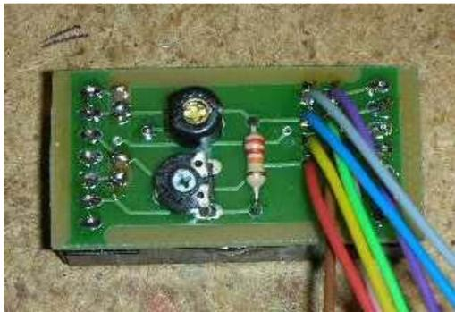
Die Bauteile C91-93 und R91-92 werden auf der Lötseite bestückt. Ihre Anschlussdrähte auf der Gegenseite werden sehr kurz gehalten, damit sie keinen Kurzschluss zum später aufgesetzten Display haben. Für die 8 Verbindungen zur Hauptplatine werden 8 dünne Litzen direkt in die Platine eingelötet. An das andere Ende dieser Litzen kommt eine 2\*4 Buchsenleiste, die auf den 2\*4 Pfostenstecker auf der Hauptplatine gesteckt wird.
